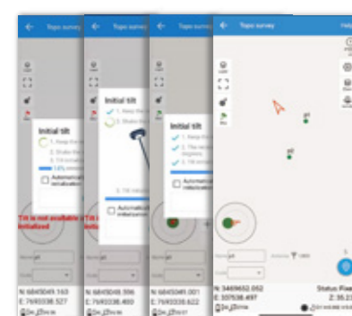
IMU Tilt Survey
